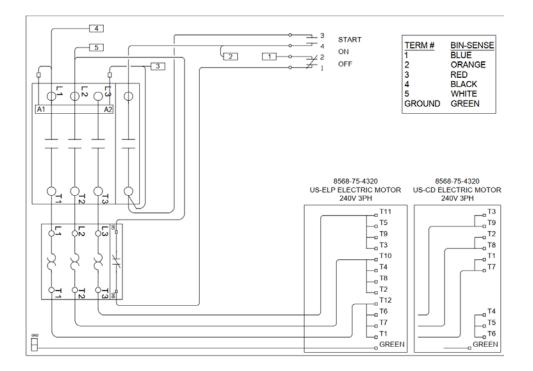
**15.6** 10HP, 15HP, 20HP, 25HP, 30HP & 40HP Full Centrifugal Fan (230V, 3PH)
